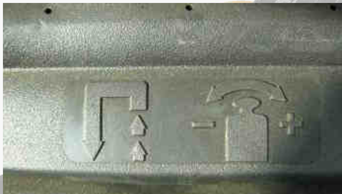
Előre-hátra, ill. fel-le mozgatható, 360°-ban elforgatható ülés terhelésállítással.
